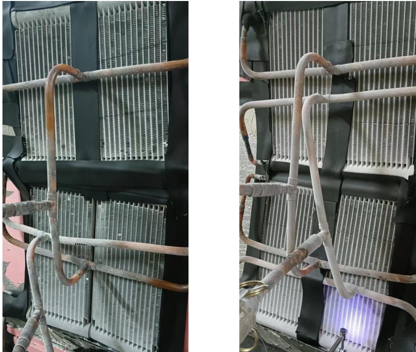
Figur 18. Testuppställningen för obelagda (vänster) och ytbelagda (höger) MCHX.
