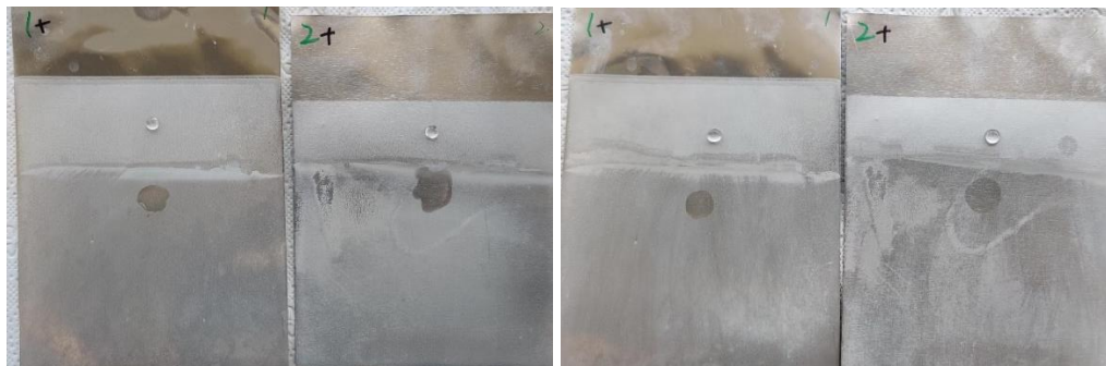
Figur 7. Bild av 2 ytbelagda Al-folier efter 260 timmar (vänster) och 500 timmar (höger) nedsänkning i 38 gradigt vatten.
