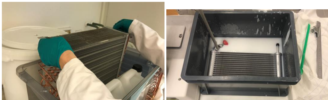
Figur 12. Manuell dipcoating av Nibe:s fin-tube värmeväxlare (vänster) och maskinell dipcoating av Danfoss' mikrokanalvärmeväxlare (höger).
