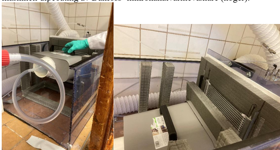
Figur 13. Beläggning av mikrokanalvärmeväxlare med nFOG-metoden.
