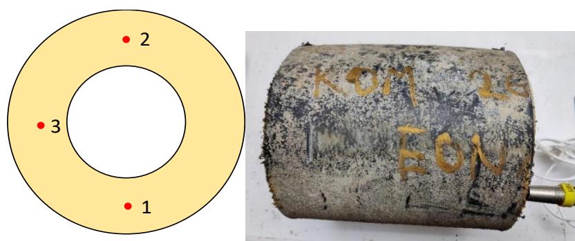
Figur 30: Vänster, schematisk sidovy med mätpositioner markerade. Uppskattad vattenmättnad upp till nivå mellan 2 och 3. Höger, bild av faktiskt prov med givare monterad i position 3
