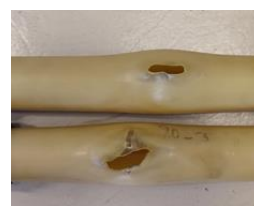
Figur 47: Bilder på brott från sprängprovningar av rör åldrade vid 80 °C
