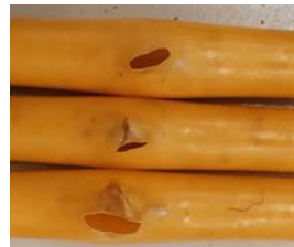
Figur 46: Bilder på brott från sprängprovningar av rör åldrade vid 90 °C
