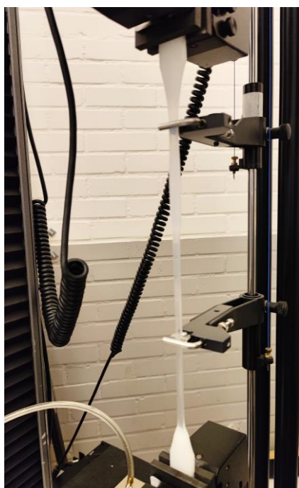
Figur 50: Dragprovning av PEX stavar enligt ISO 6549-3
