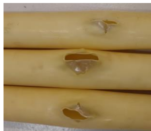
Figur 48: Bilder på brott från sprängprovningar av rör åldrade vid 70 °C
