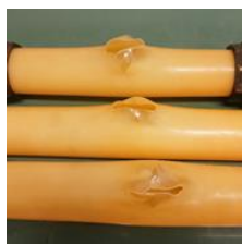
Figur 46: Bilder på brott från sprängprovningar av rör åldrade vid 90 °C
