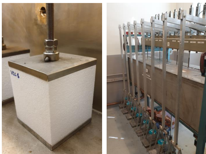
Figur 59: Krypprov av EPS vid förhöjd temperatur via varmt vatten. Överst visa EPS prov i balja som fyllts med varmt vatten. Nederst till vänster visas belastad prov och nederst till höger visas hävarmar med belastning
