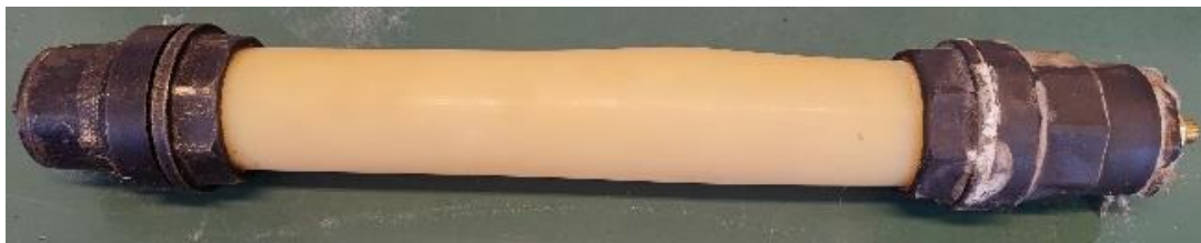
Figur 44: Rörprov med kopplingar för sprängprovning
