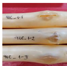
Figur 46: Bilder på brott från sprängprovningar av rör åldrade vid 90 °C
