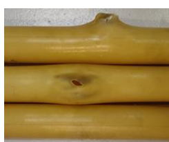
Figur 47: Bilder på brott från sprängprovningar av rör åldrade vid 80 °C
