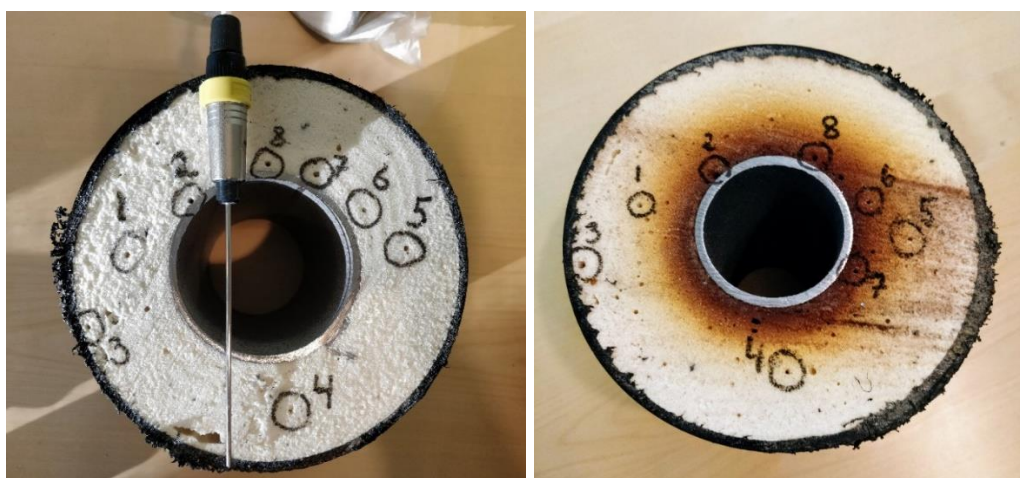
Figur 26: Jungfruligt ledning och TLS-givare (vänster). Åldrad ledning från samma produktionstillfälle (höger). Mätpunkter inringade och numrerade
