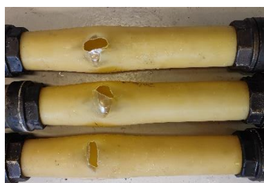
Figur 48: Bilder på brott från sprängprovningar av rör åldrade vid 70 °C
