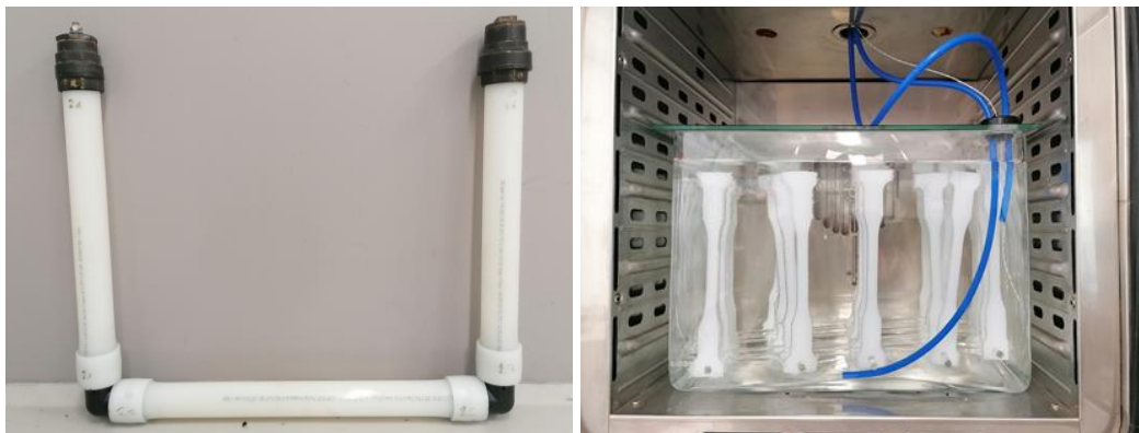
Figur 14: Till vänster tre rörprover av PEX för åldring under tryck 6 bar och temperaturer 70, 80 och 90 °C. Till höger åldring av provstavar från PEX-rör i vanner med cirkulerande vatten vid samma temperaturer.
