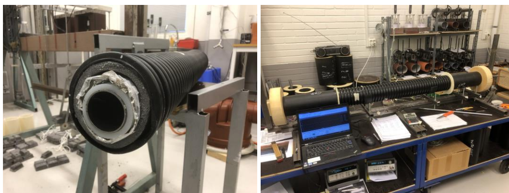
Figur 55: Flexibel FV-ledning isolerad med vacuumpanel och PEX-skum till vänster och till höger visas laboratorieuppställning för mätning av termisk konduktivitet
