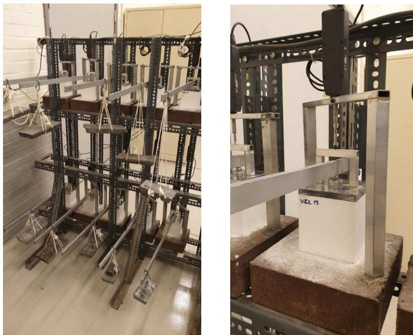
Figur 58: Krypprov av EPS i laboratoriemiljö
