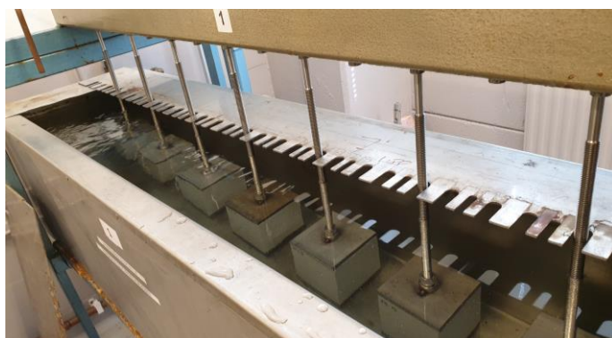
Figur 58: Krypprov av EPS i laboratoriemiljö
