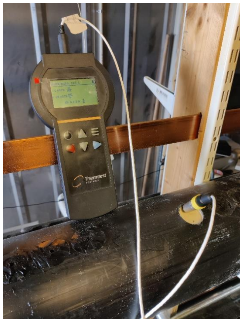
Figur 5: Mätning av termisk konduktivitet med Thermtest TLS-100 via hål upptaget i manteln
