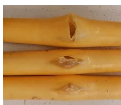
Figur 47: Bilder på brott från sprängprovningar av rör åldrade vid 80 °C
