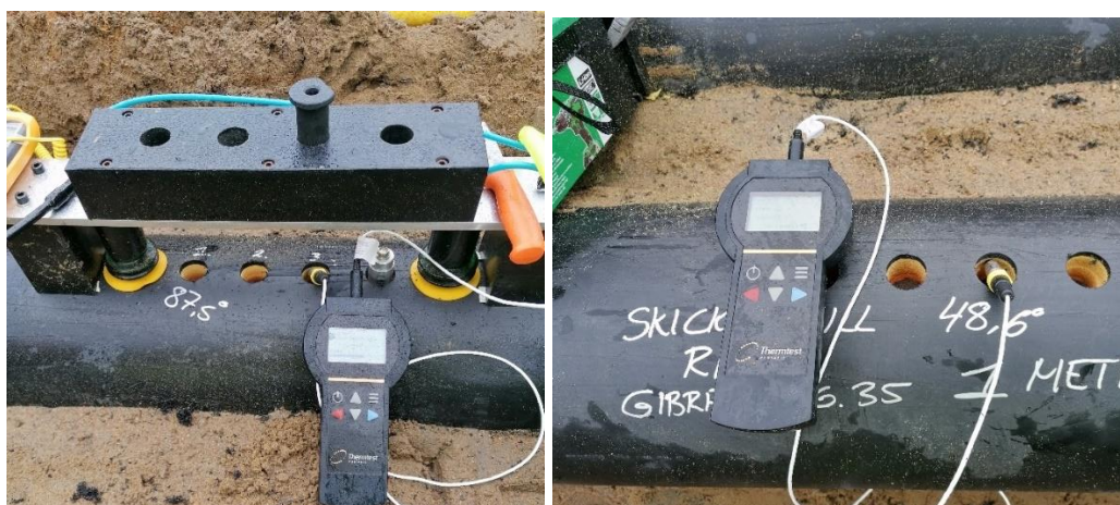
Figur 29: Mätning av termisk konduktivitet i fält
