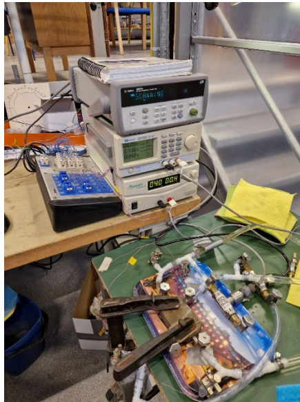
Figur 2: Försöksuppställning visande datalogger, överst, spänningsaggregat för pumpar, mätlåda för termoelementens kalla lödställe samt i förgrunden värmeväxlaren med anslutningar, termoelement och differensstryckgivare.
