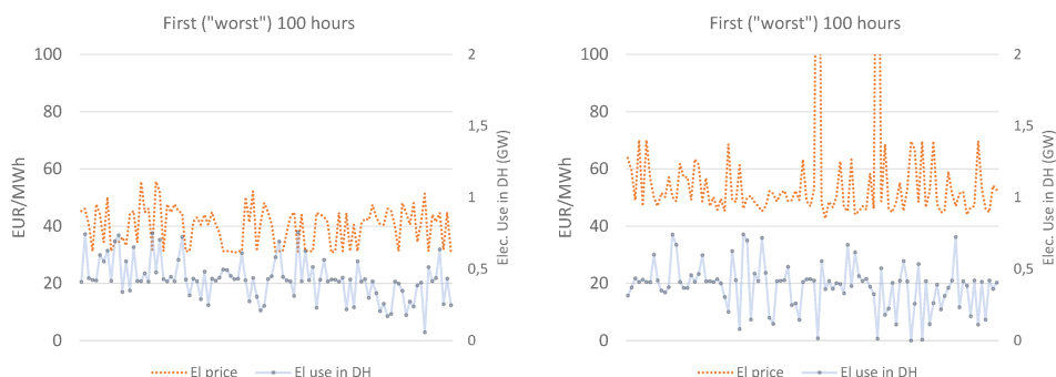
Figur 43: Elanvändningen i fjärrvärmesystemen i Figur 42 plottad mot elpriset i SE3 i Basfallet (till vänster) respektive "Mer förnybart utan KK" (till höger); modellår 2030. Elanvändningen läses av mot den högra y-axeln och elpriset mot den vänstra axeln. Electricity use in Swedish district-heating systems taken from previous figure and corresponding electricity price (price area SE3). Base case shown in the left panel and "More renewables without nuclear" case shown in the right panel; model year 2030.
