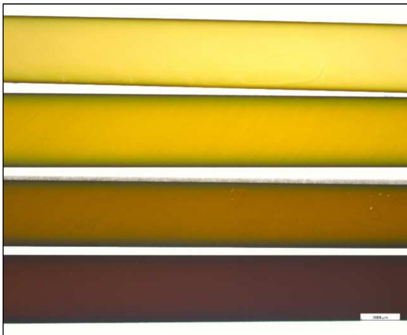
Figur 3. Tvärsnitt av exponerade prover. Överst i bild är 120C i 7 dagar följt av 14 dagar 120°C, 7 dagar i 140°C samt 14 dagar i 140C.
