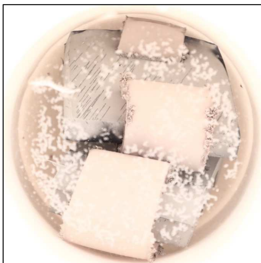
Figur 16. Gummimaterial som uppvisade en tydlig missfärgning av exponeringsvattnet samt en vit beläggning på proverna efter åldringen
