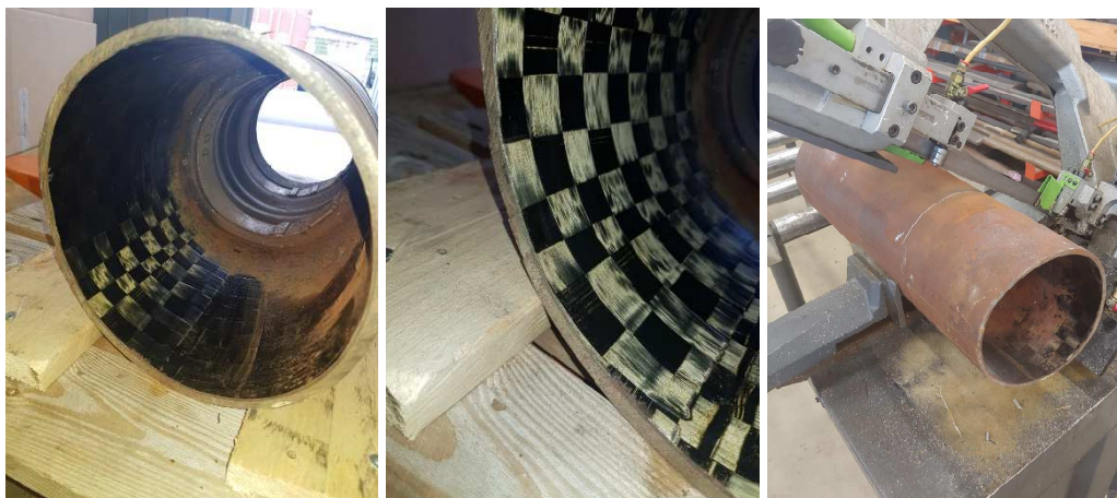
Figur 30: Det avvecklade och utgrävda stålröret inklusive infodringen skars i mindre bitar för att möjliggöra analys
