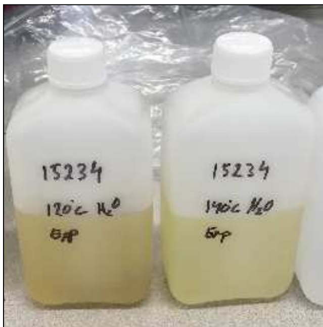
Figur 4. Exponeringsvattnet efter 161 dagar i 120°C och 140°C.
