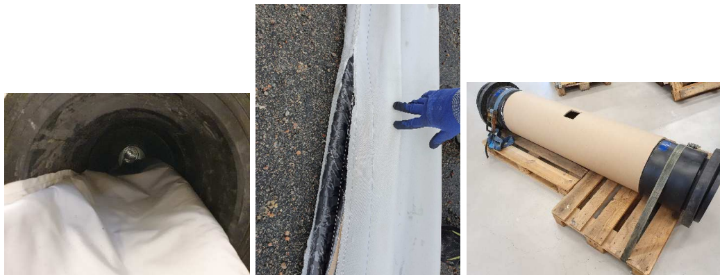
Figur 34: Olika sprängpåsar utvärderades (vänster och mitten) genom att använda en testrigg (höger)
