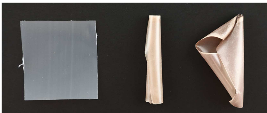
Figur 14. Den exponerade folien före och efter 7 dygns exponering i 120°C och 140°C.
